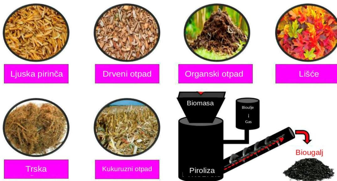
Slika 1. Način i sirovine za dobijanje biouglja [4]
